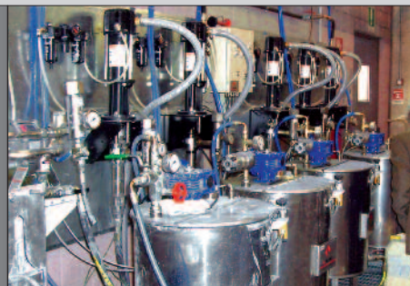
2х шаровой поршневой насос с коэффициентом 11:1 используется для циркуляции красок.
