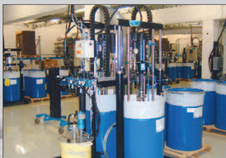
Экструзионные насосы с коэффициентом 23:1 используются для транспортировки силикона.
