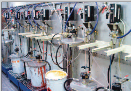
2х шаровой поршневой насос с коэффициентом 4:1 используется для процесса нанесения красок.
